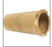
Néanmoins ils s'oxydent et se colmatent à la longue et doivent donc être changés régulièrement de façon à ne pas réduire les performances des détendeurs. En cas de colmatage important, ils risquent d'exploser et d'envoyer une multitude de billes dans le mécanisme du détendeur. On peut regretter que sur plusieurs détendeurs récents on ne puisse les vérifier sans démontage.
