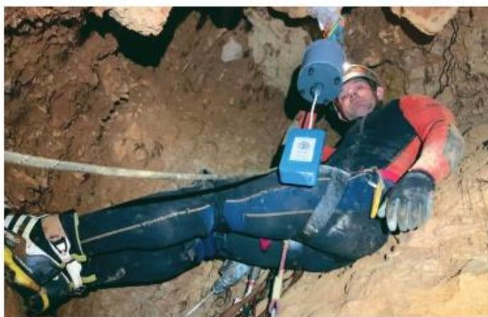
Avant de creuser l'ouverture de la trémie de St Thamié, il a fallu localiser le point en surface à la verticale de la bobine magnétique. © Pierre Gougil.
